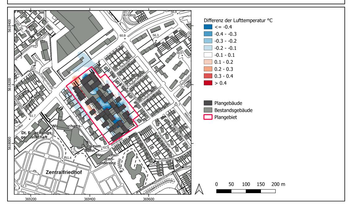
Lufttemperatur in 1,5 m Höhe über Grund um 4 Uhr bei einer westlichen Anströmungsrichtung - Istfall -
