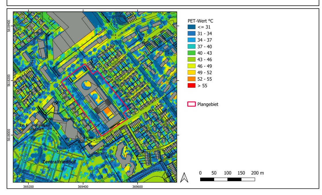
PET-Wert in 1,5 m Höhe über Grund um 14 Uhr bei einer südöstlichen Anströmungsrichtung - Planfall -
