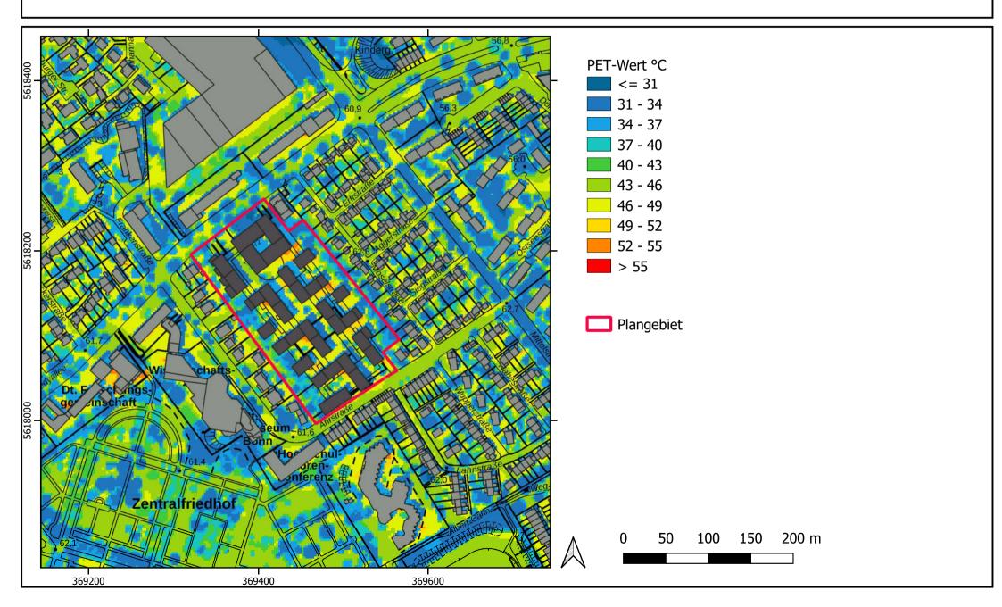
Differenz des PET-Wertes in 1,5 m Höhe über Grund um 14 Uhr bei einer westlichen Anströmungsrichtung - Planfall minus Istfall -
