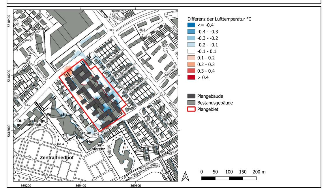
Lufttemperatur in 1,5 m Höhe über Grund um 22 Uhr bei einer westlichen Anströmungsrichtung - Istfall -
