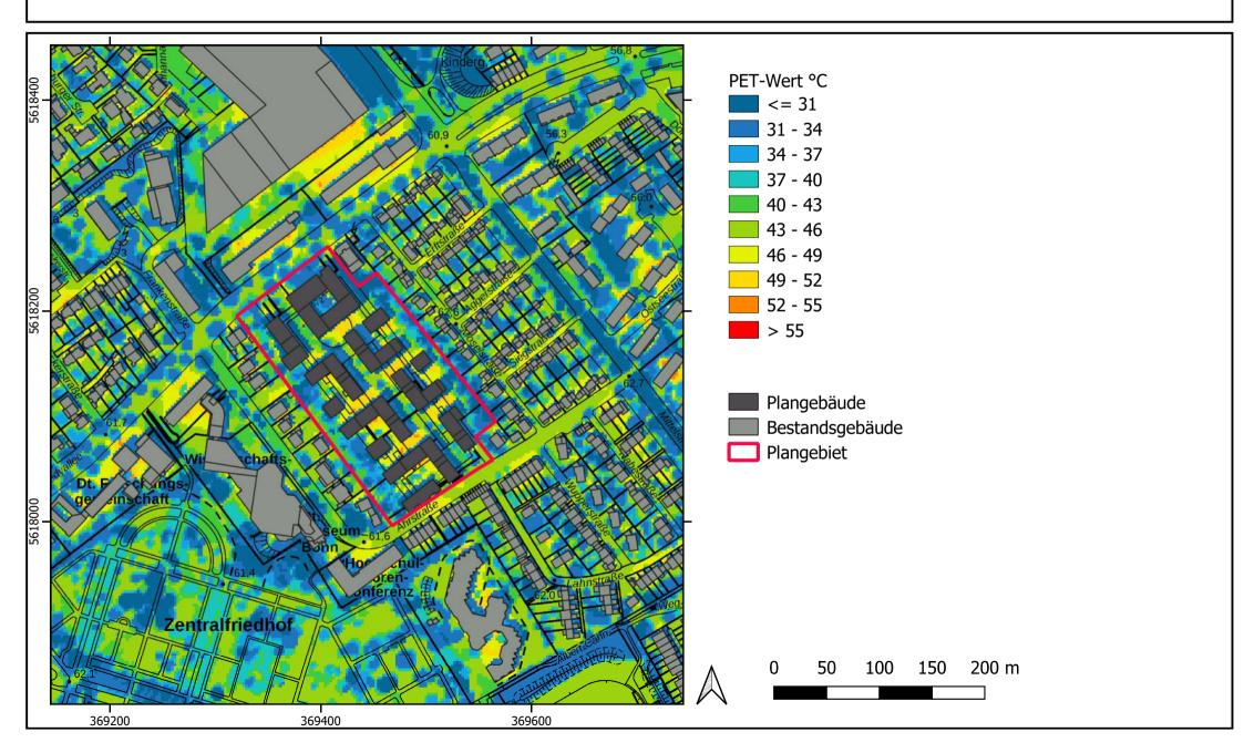
Differenz des PET-Wertes in 1,5 m Höhe über Grund um 14 Uhr bei einer südöstlichen Anströmungsrichtung - Planfall minus Istfall -
