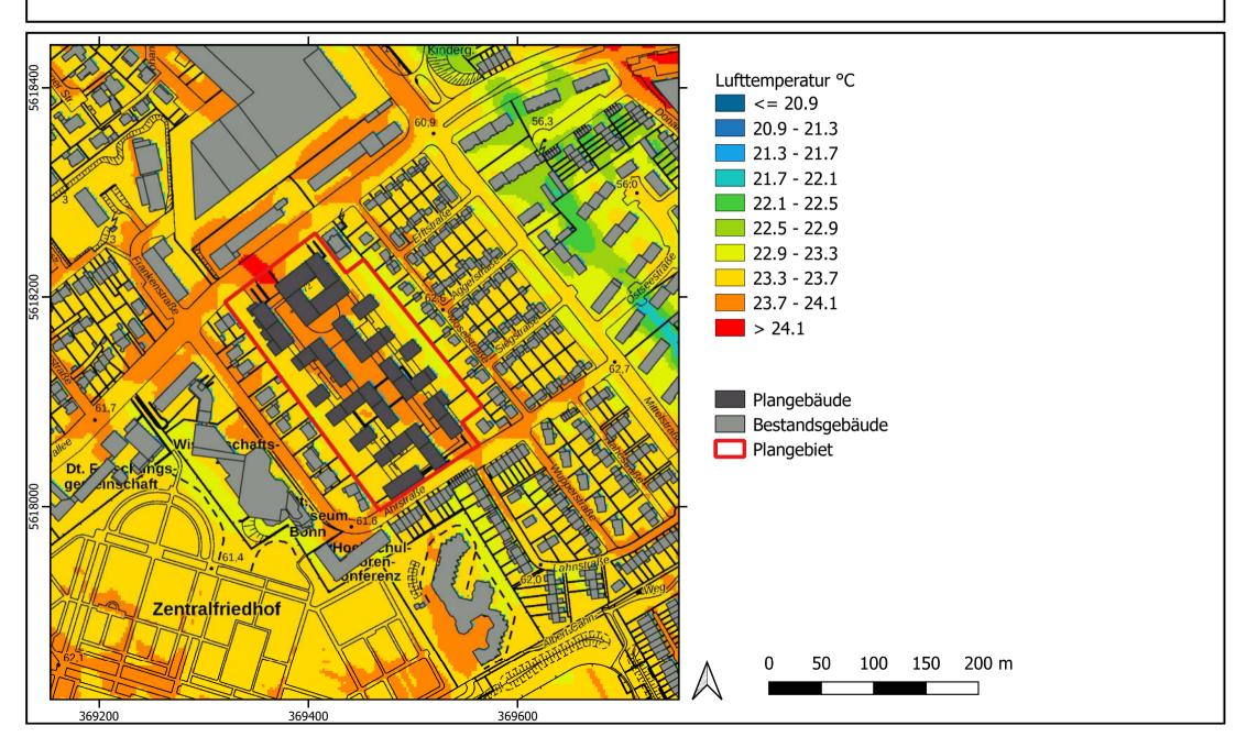
Differenz der Lufttemperatur in 1,5m Höhe über Grund um 22 Uhr bei einer südöstlichen Anströmungsrichtung - Planfall minus Istfall -
