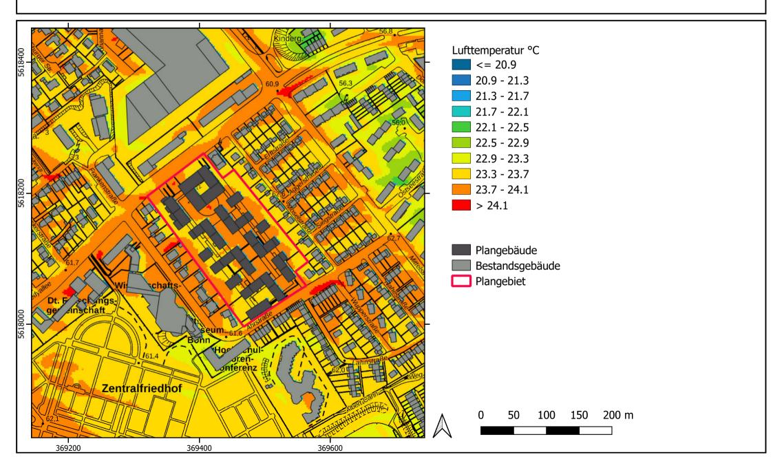
Differenz der Lufttemperatur in 1,5 m Höhe über Grund um 22 Uhr bei westlicher Anströmrichtung - Planfall minus Istfall -
