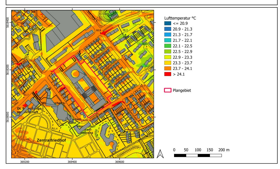
Lufttemperatur in 1,5 m Höhe über Grund um 22 Uhr bei einer westlichen Anströmungsrichtung - Planfall -
