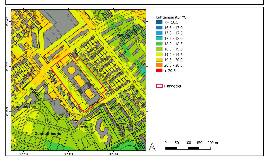
Lufttemperatur in 1,5 m Höhe über Grund um 4 Uhr bei einer südöstlichen Anströmungsrichtung - Planfall -
