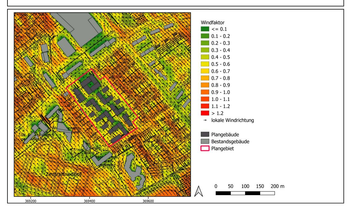
Differenz des Windfaktors in 10 m Höhe über Grund bei einer südöstlichen Anströmungsrichtung - Planfall minus Istfall-
