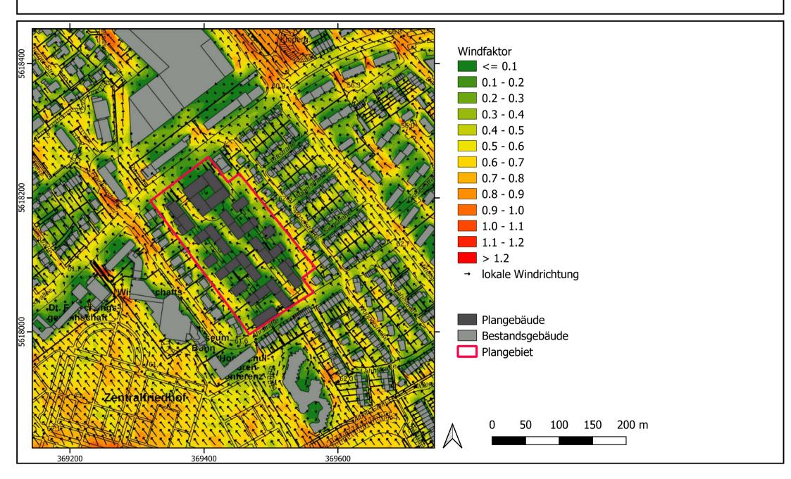
Differenz des Windfaktors in 1,5 m Höhe über Grund bei einer südöstlichen Anströmungsrichtung - Planfall minus Istfall-
