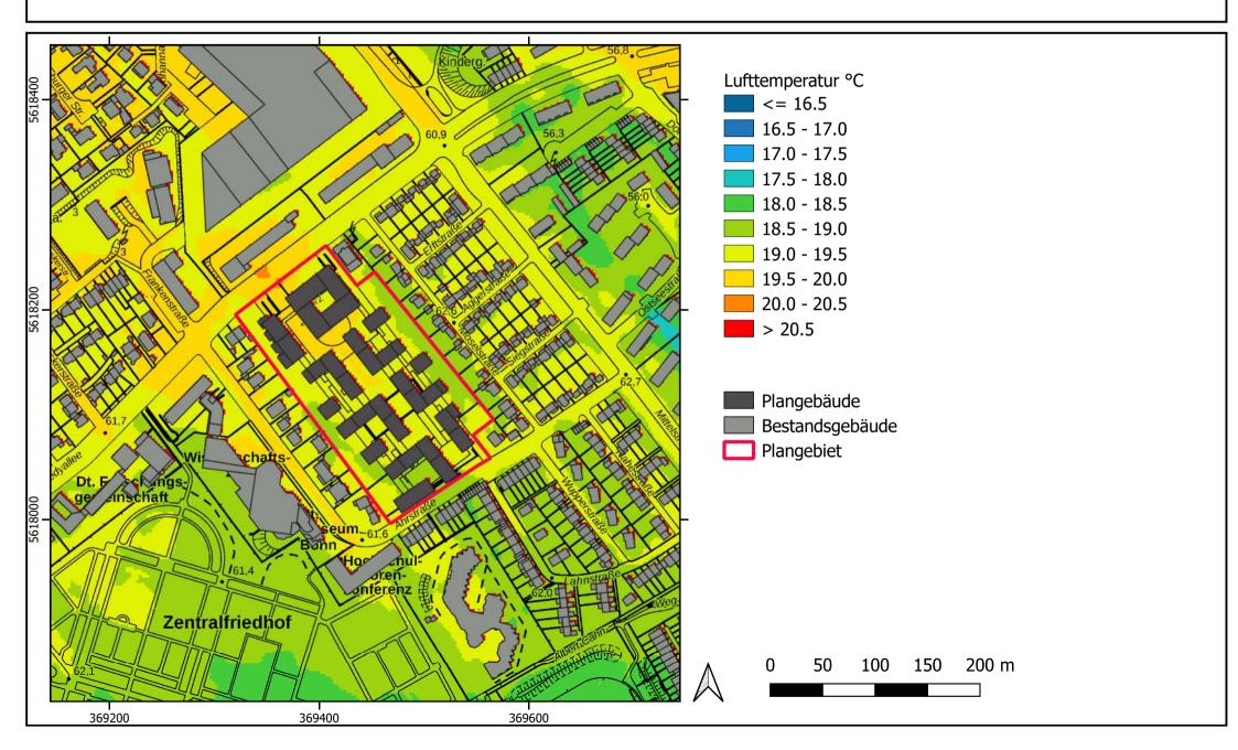
Differenz der Lufttemperatur in 1,5 m Höhe über Grund um 4 Uhr bei einer südöstlichen Anströmungsrichtung - Planfall minus Istfall-
