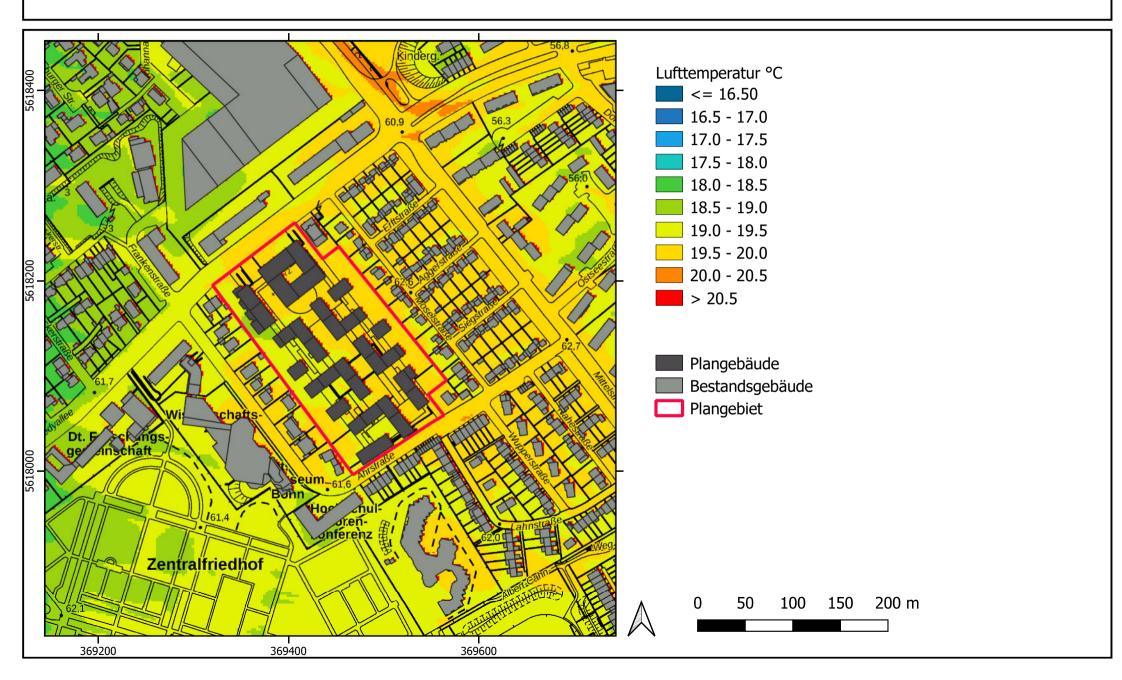
Differenz der Lufttemperatur in 1,5 m Höhe über Grund um 4 Uhr bei einer westlichen Anströmungsrichtung - Planfall minus Istfall-
