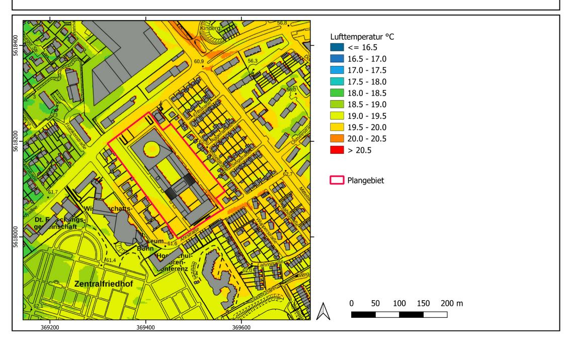
Lufttemperatur in 1,5 m Höhe über Grund um 4 Uhr bei einer westlichen Anströmungsrichtung - Planfall -
