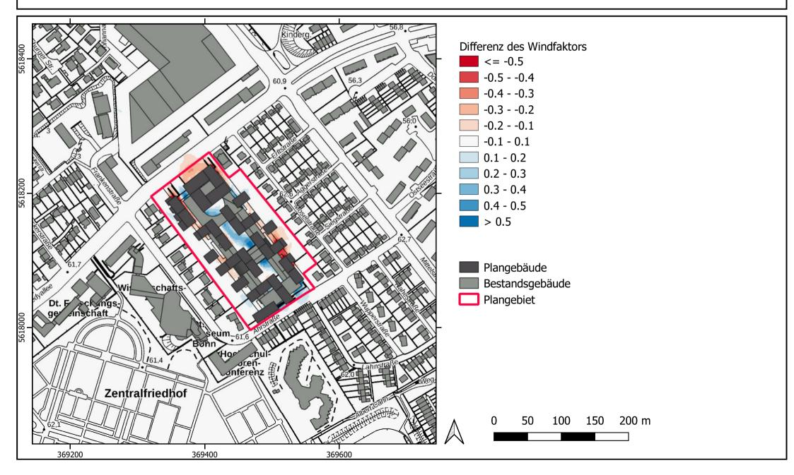
Windfeld in 1,5m Höhe über Grund bei einer westlichen Anströmungsrichtung - Istfall -
