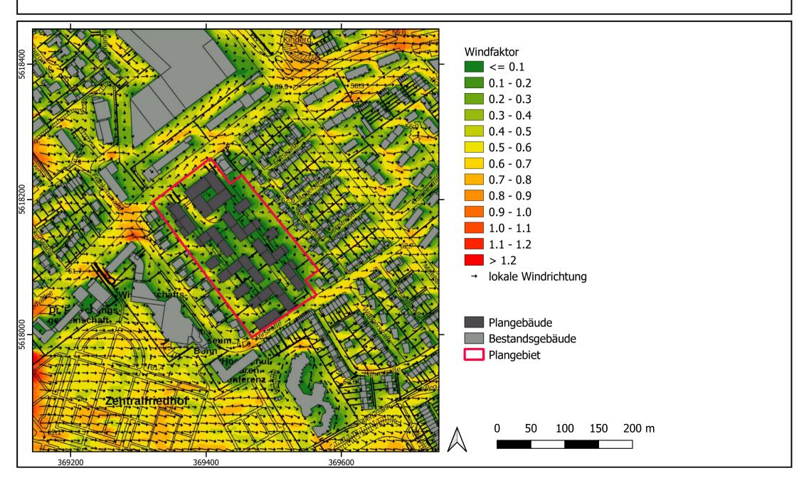
Differenz des Windfaktors in 1,5 m Höhe über Grund bei einer westlichen Anströmungsrichtung - Planfall minus Istfall-
