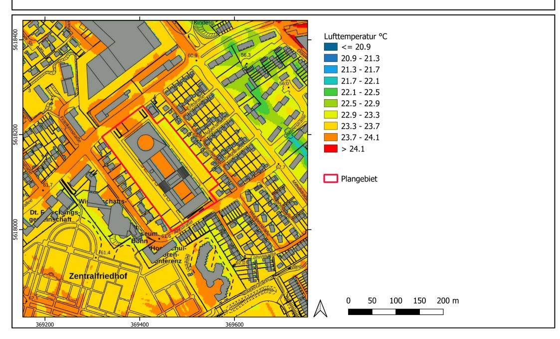
Lufttemperatur in 1,5m Höhe über Grund um 22 Uhr bei einer südöstlichen Anströmungsrichtung - Planfall -
