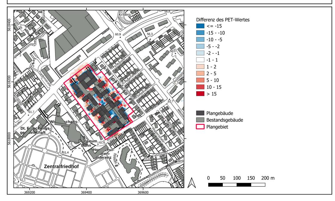
PET-Wert in 1,5 m Höhe über Grund um 14 Uhr bei einer westlichen Anströmungsrichtung - Istfall -
