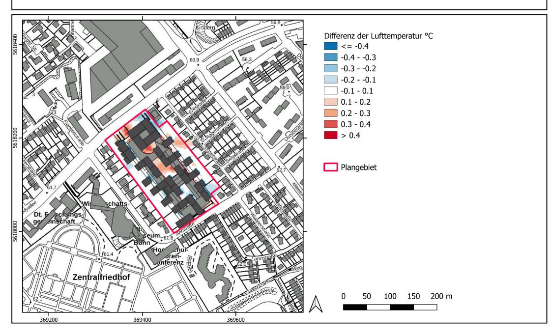
Lufttemperatur in 1,5 m Höhe über Grund um 4 Uhr bei einer südöstlicher Anströmungsrichtung - Istfall -
