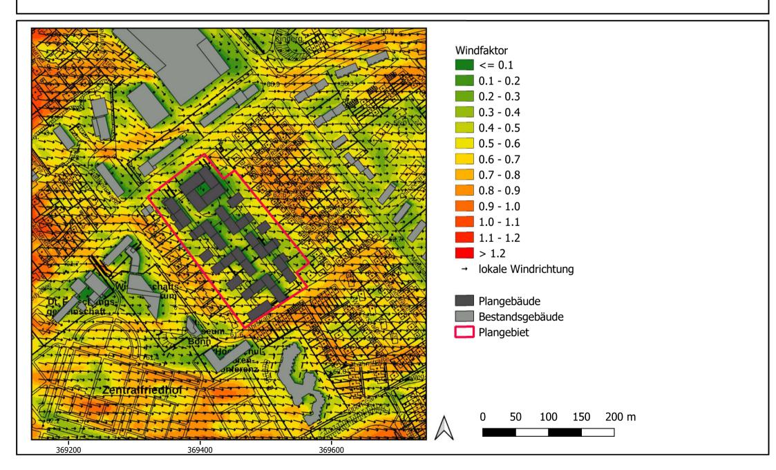
Differenz des Windfaktors in 10 m Höhe über Grund bei einer westlicher Anströmungsrichtung - Planfall minus Istfall-
